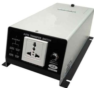
자동전환 스위치 Automatic Transfer Switch는 이중 또는 삼중전원을 확보하여 주전원정전 시 또는 전압이 기준치 이하로 떨어질 경우 예비전원으로 자동전환 함으로서 수용가가 항상 일정한 전원공급을 받을 수 있도록 하는 장치이다. 자동으로 주 전원 입력의 정전에 의해서 보조 전원 입력이 자동으로 전환을 하여 항상 부하에 무 정전으로 전원을 공급한다. 보조 전원에 의해 전원공급을 유지하다가 주전원 입력이 다시 투입되면 보조전원에서 주전원으로 자동으로 전환된다.
