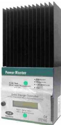
충전컨트롤러의 주 기능은 배터리의 정상적인 충전을 통해 배터리의 용량을 최대한 사용하면서 수명을 연장시켜주는 것으로 태양광 또는 풍력발전기에 모두 적용된다. 충전컨트롤러의 기능은 전류의 역방향흐름을 방지하고 과충전을 방지하는 것이다. 일부는 과방전을 막고 과부하를 차단하는 기능과 배터리의 충전상태와 전력의 흐름을 표시하는 디스플레이 기능을 포함한 것도 있다.
