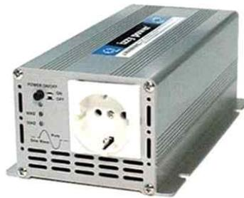
(1) 태양광발전시스템에서 만들어지는 전기는 DC전기기기 때문에 이 전기를 가정에서 사용하거나 계통에 전기를 팔기 위해선 DC전압을 AC 전압으로 변환 시켜줘야 한다. 이것을 크게 독립형 인버터와 계통연계형 인버터로 나눌 수 있는데 계통과 상관없이 독립적으로 사용하는 것을 독립형 인버터라 하고, 계통(전력회사)로 전기를 팔기 위한 인버터는 계통연계형 인버터라 한다. 독립형에 사용하는 인버터는 크게 정현파 인버터와 유사 정현파 인버터로 구분될 수 있다.
