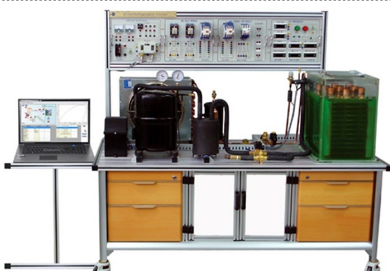
AI 브라인 냉동 (빙축 냉동) 실습 장비 [AI-6000BR]
